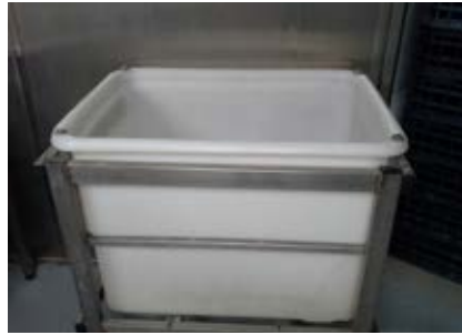
Fig. 3.2.14 Tanque de plástico ▶ para el lavado de moldes.
