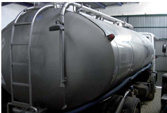
Imagen 5.8. Cisterna para la recogida y transporte de la leche a fábrica.
