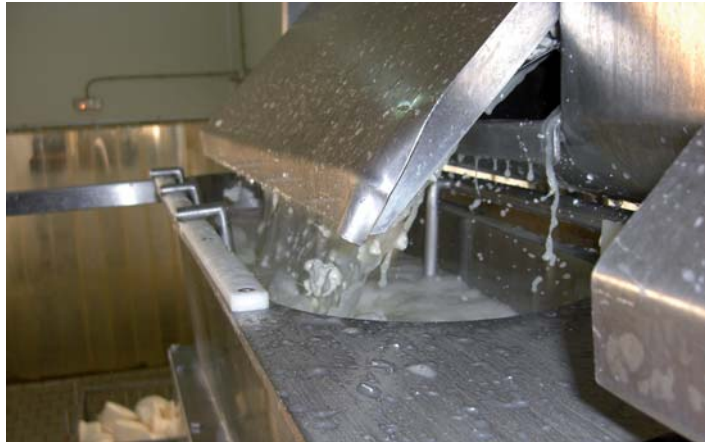
Imagen 5.7. Lactosuero de la cuajada en llenadora automática de moldes.
