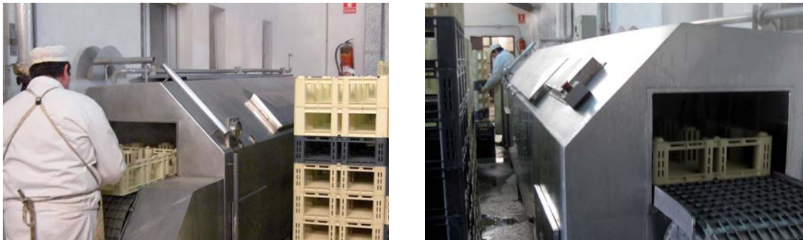
Imagen 5.2. Proceso de lavado de cajas.
