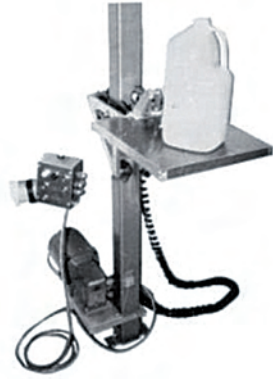
Figura 32. Equipo empleado en el ensayo de impacto por caída libre.
