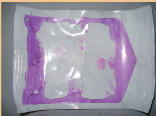
Figura 45. Ejemplo de ensayo de detección de fugas mediante método de penetración de disolución colorante.
