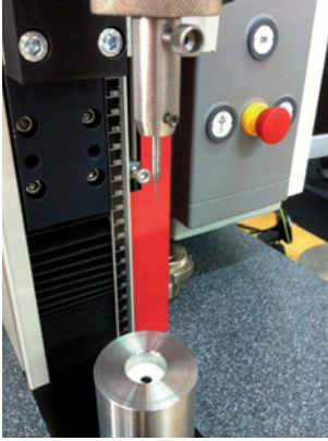
Figura 35. Fotografía de detalle del equipo de punzón (por cortesía de Zwick/Roell).
