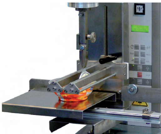
Figura 27. Ensayo de separación por pelado sobre tarrina con tapa de film (por cortesía de Zwick/Roell).
