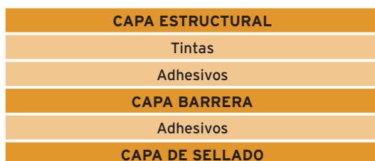
Figura 18. Representación esquemática de una estructura tipo de un film multicapa.
