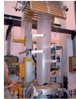
Figura 4. Esquema del proceso de extrusión soplado de globo e imagen del globo formado por el film plástico.
