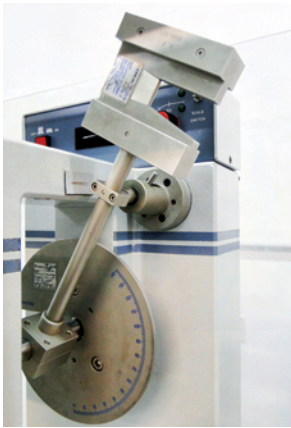
Figura 29. Equipo empleado para la determinación de impacto Charpy e Izod.
