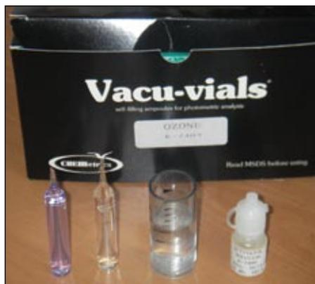
**Figura 8.2:** Ejemplo de un kit para la medición de ozono
